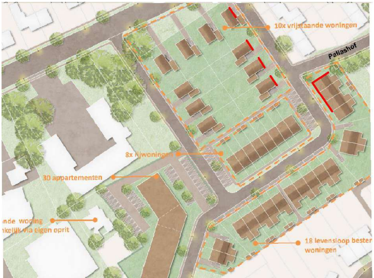
Figuur 4.1 gevels met een overschrijding van de ten hoogste toelaatbare geluidsbelasting.
