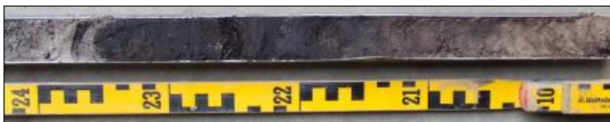
Figuur 20: Boring V-4 met een door grof zand (links) afgedekte veenlaag (midden) die naar beneden toe (rechts) geleidelijk overgaat in fijner zand met humusbandjes
