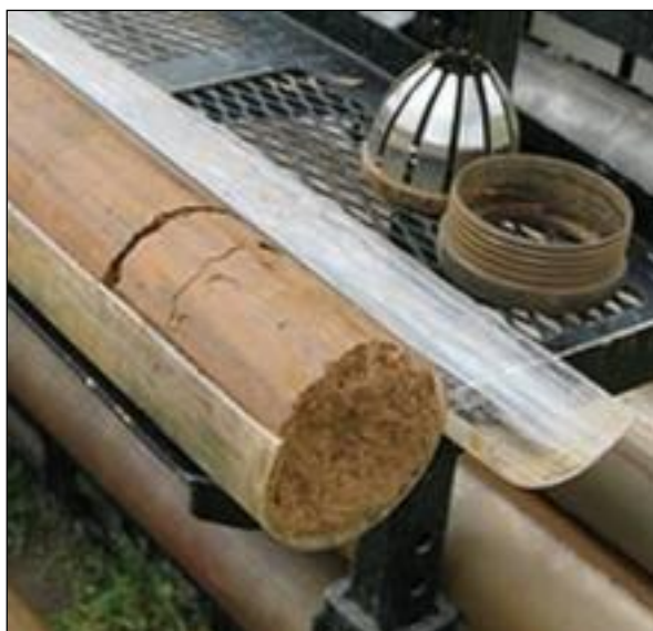
Figuur 19: Voorbeeld van het gebruik van bodemprofielbuizen bij mechanische ramgutsboringen.
