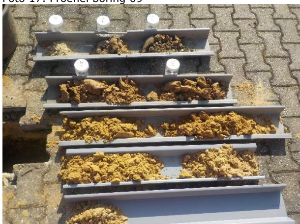
Foto 19. Profiel boring tot 5 m-mv, boring 14
