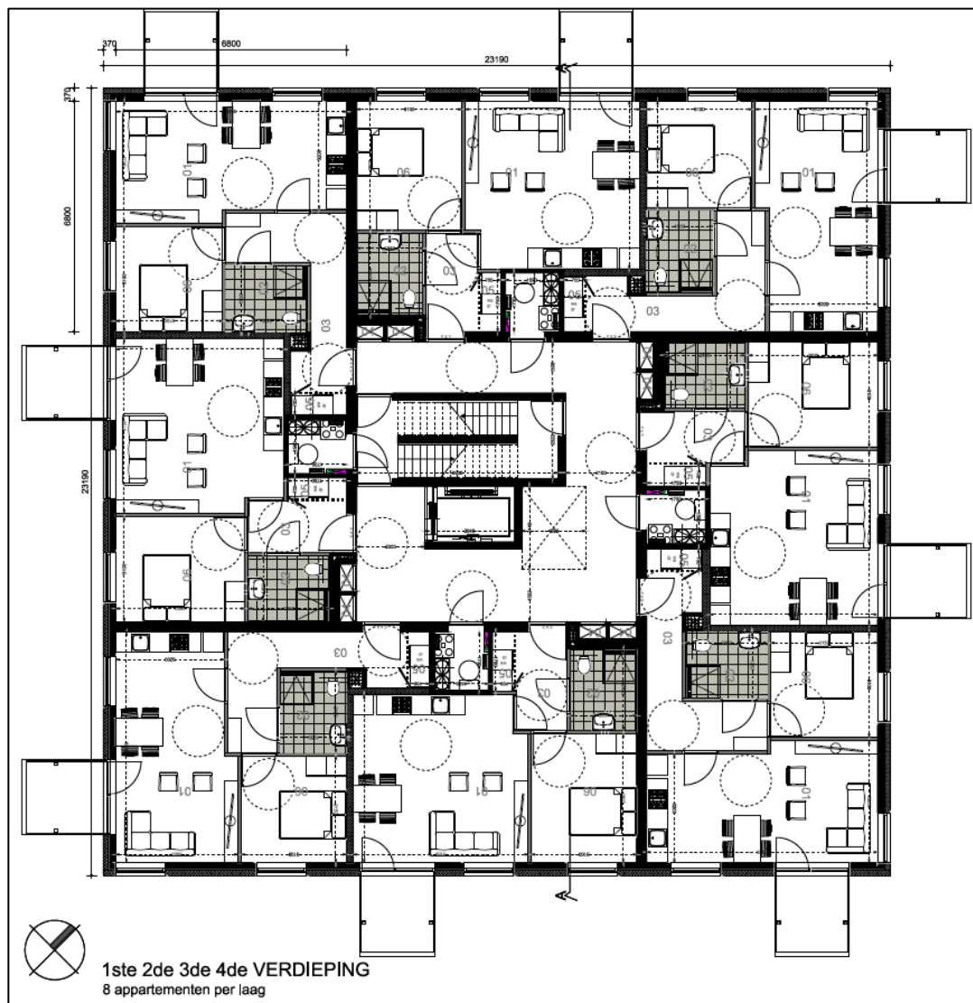
Plattegrond eerste, tweede, derde en vierde verdieping
