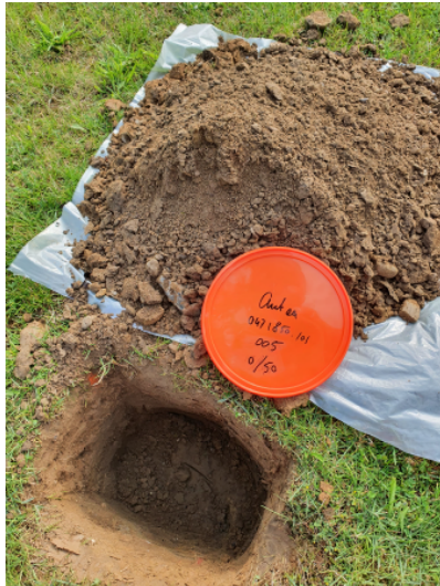
Foto: materiaal proefgat 5 (0-50)
