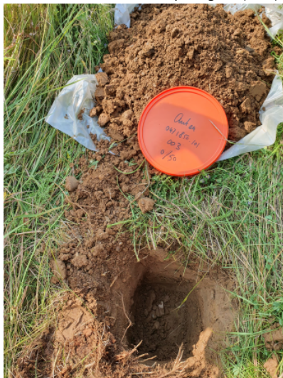
Foto: materiaal proefgat 3 (0-50)
