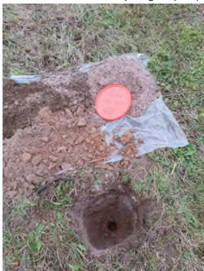
Foto: materiaal proefgat 9 (15-35)
