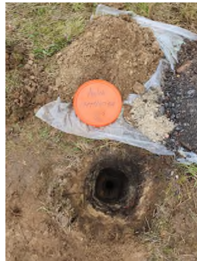
Foto: materiaal proefgat 5 (0-20)
