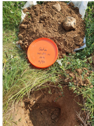
Foto: materiaal proefgat 4 (0-50)
