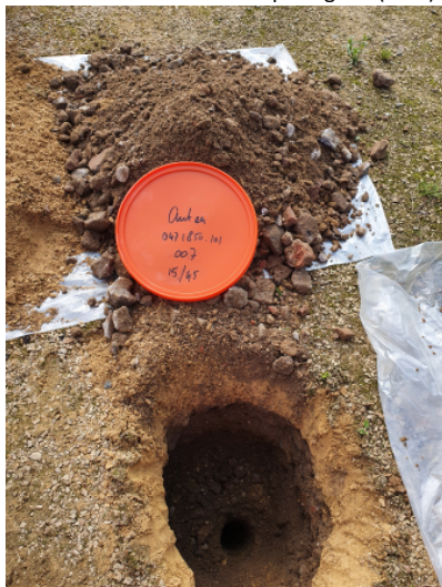
Foto: materiaal proefgat 7 (15-45)
