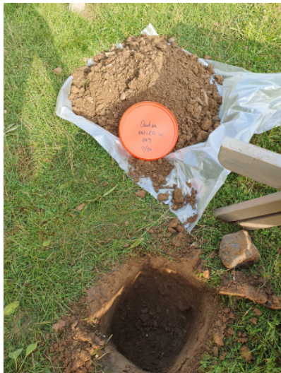
Foto: materiaal proefgat 9 (0-50)
