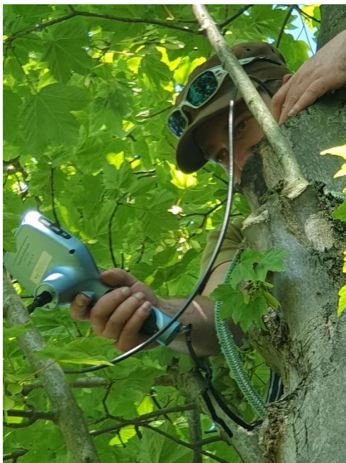
Inspectie met boomcamera en indruk binnenzijde van een holte.
